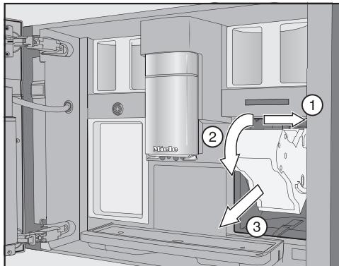
■ まず、抽出ユニットを横に引き①、前方にスライドさせて出します②。抽出ユニットを前方に傾けます③。
