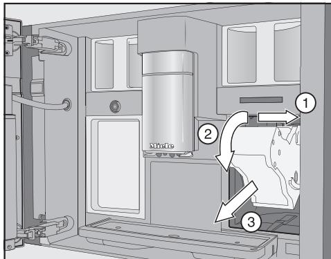
■ まず、抽出ユニットを横に引き①、前方にスライドさせて出します③。抽出ユニットを前方に傾けます②。
