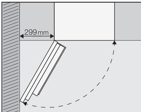
壁などと本製品の間に少なくとも 299 mm のスペースがあることを確認してください。ドアを開けて左側の豆コンテナ（ドアの最低開口角度 120°）を取り出す場合にこのスペースが必要です。
