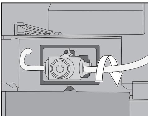
**ヒント:** 必要に応じて、右側の接続部品でミルクパイプを後ろに向けて回転します。
