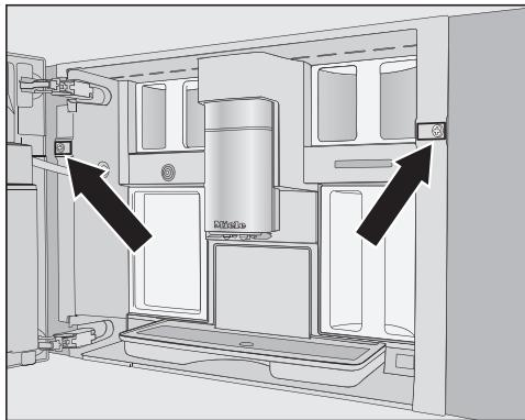
TX 20 (25 mm) ネジ 2 個が本製品に付属しています。
