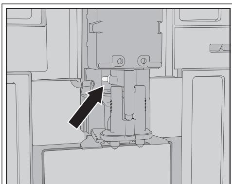
ミルクパイプの接続部品は外さないでください。必要であれば、接続部品をクリーニングブラシで清掃します。
